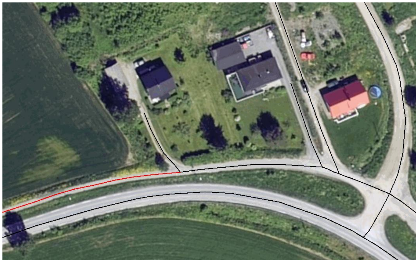
Figur: Gang- og sykkelveg registrert som Vegsenterlinje (svart) der den brukes som tilkjøring til boliger og GangSykkelveg ellers (rødt).
